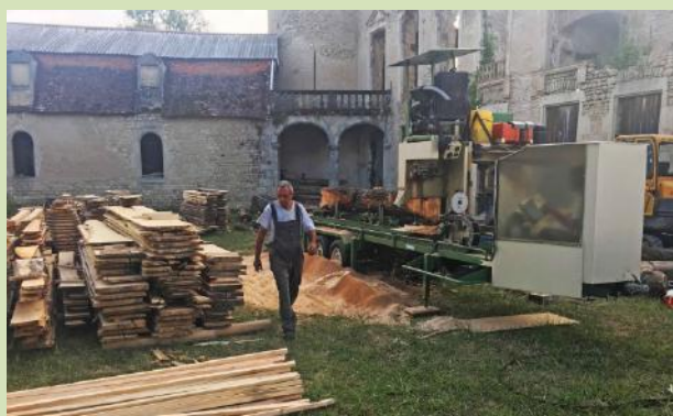
installation de la scierie mobile
